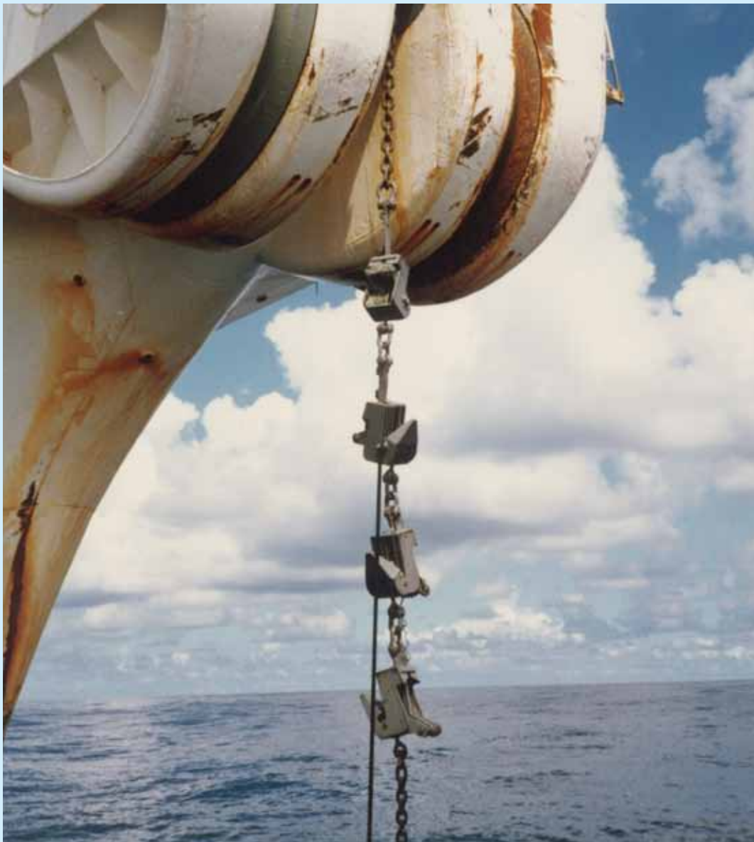
カットアンドホールドグラブネルによる通信ケーブル引き上げ作業 Submarine Cable Lifting Up Work with Cut and Hold Grapnels
